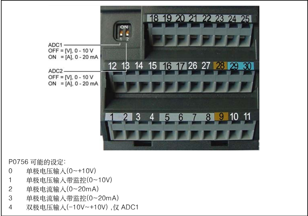
图 3-28 用于 ADC 电流/电压输入的 DIP 开关和 P0756
